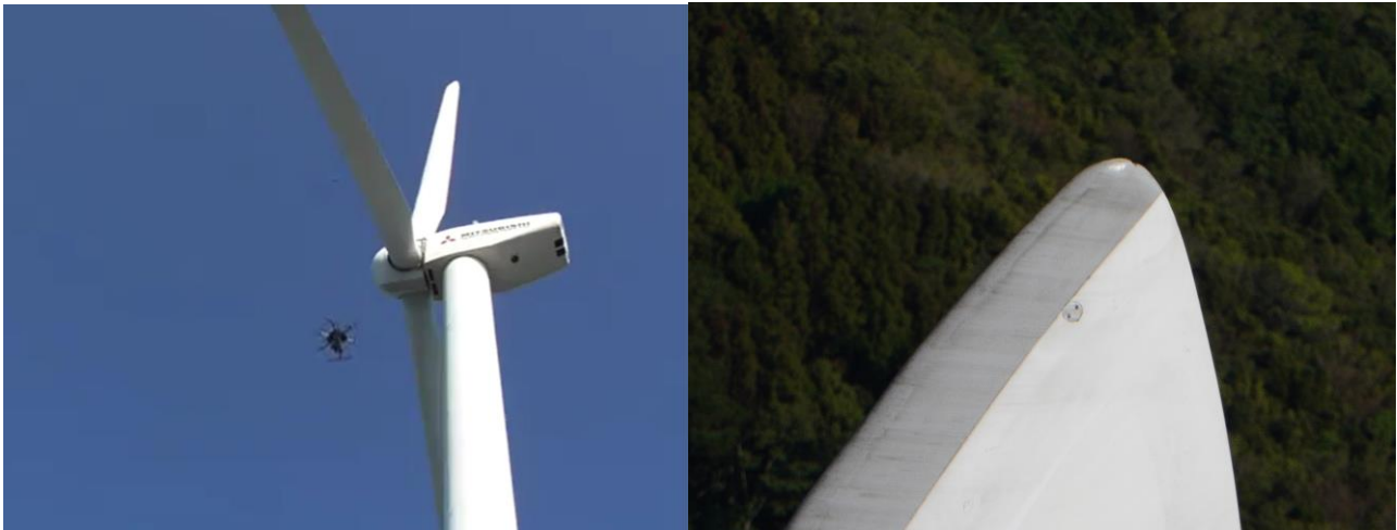
左：風力発電機の周りを自律飛行で撮影するドローンの様子
