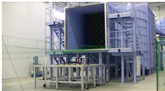
風洞試験 安全性を向上することを目的に、航空力学上のドローンの最適な飛行を研究。
