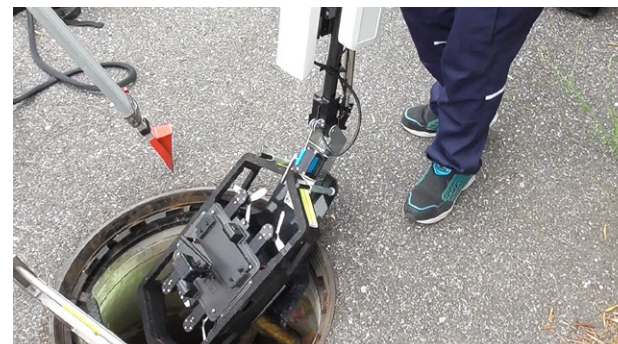
下水管にFi4をおろす 機体開発や生産にとどまらず、下水道点検全体のオペレーションに合わせたソリューション構築。 (NJSとの合併会社FINDi)
