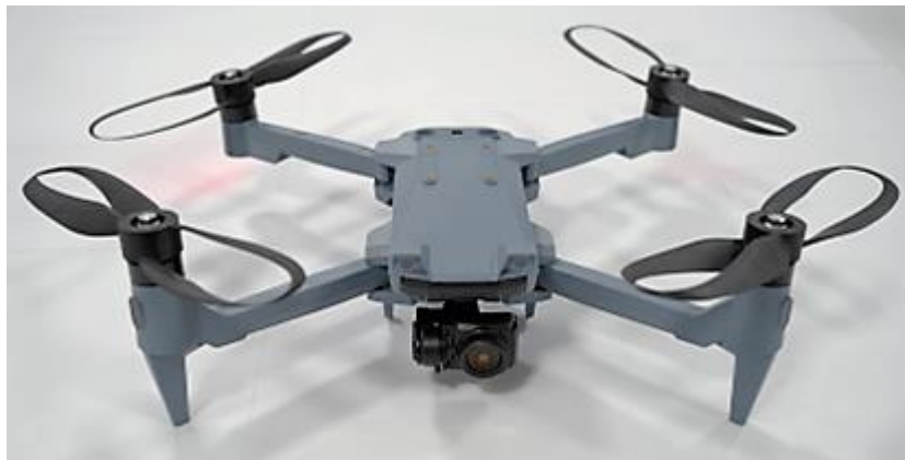
図1 新規開発プロペラを搭載したSOTEN ©JAXA/ACSL
