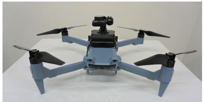
上部カメラマウントを搭載し、標準カメラを設置した SOTEN（蒼天）
