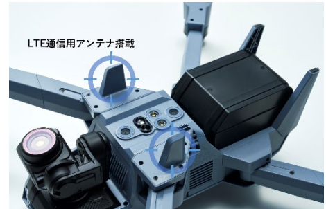
SOTEN の LTE 通信用アンテナ
