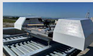
仙台市 津波避難広報ドローンシステム
